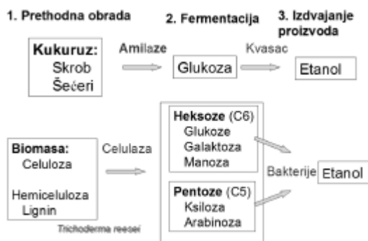
Слика 10.8: Технолошки процес производње етанола из биомасе
