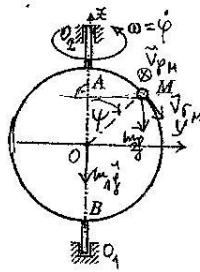
Disk poluprečnika  $R$  (vertikalni), mase  $m_1$ , može da se obrće oko vertikalne  $O_1$  osovine. U  $O_1$  je sferno, a u  $O_2$  cilindrično ležište. Po obodu diska može da se kreće kuglice  $M$  (materijalna tačka) mase  $m_2$ . U  $t_0=0$ , disk je imao ugaonu brzinu  $\omega_0$  a kuglica  $M$  je zanemarljivo malom brzinom krenula iz položaja  $A$ . Odrediti ugaonu brzinu diska kada je kuglica  $M$  na  $Oy$  osi.
