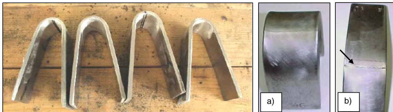
Slika 25: Izgled epruveta sučeonog spoja limova nakon ispitivanja poprečnim savijanjem: a) zadovoljavajući, b) nezadovoljavajući
